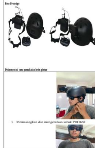
PROTOTYPE HELM DETEKSI EKSPRESI WAJAH BERBASIS DEEP LEARNING (PROKSI)
